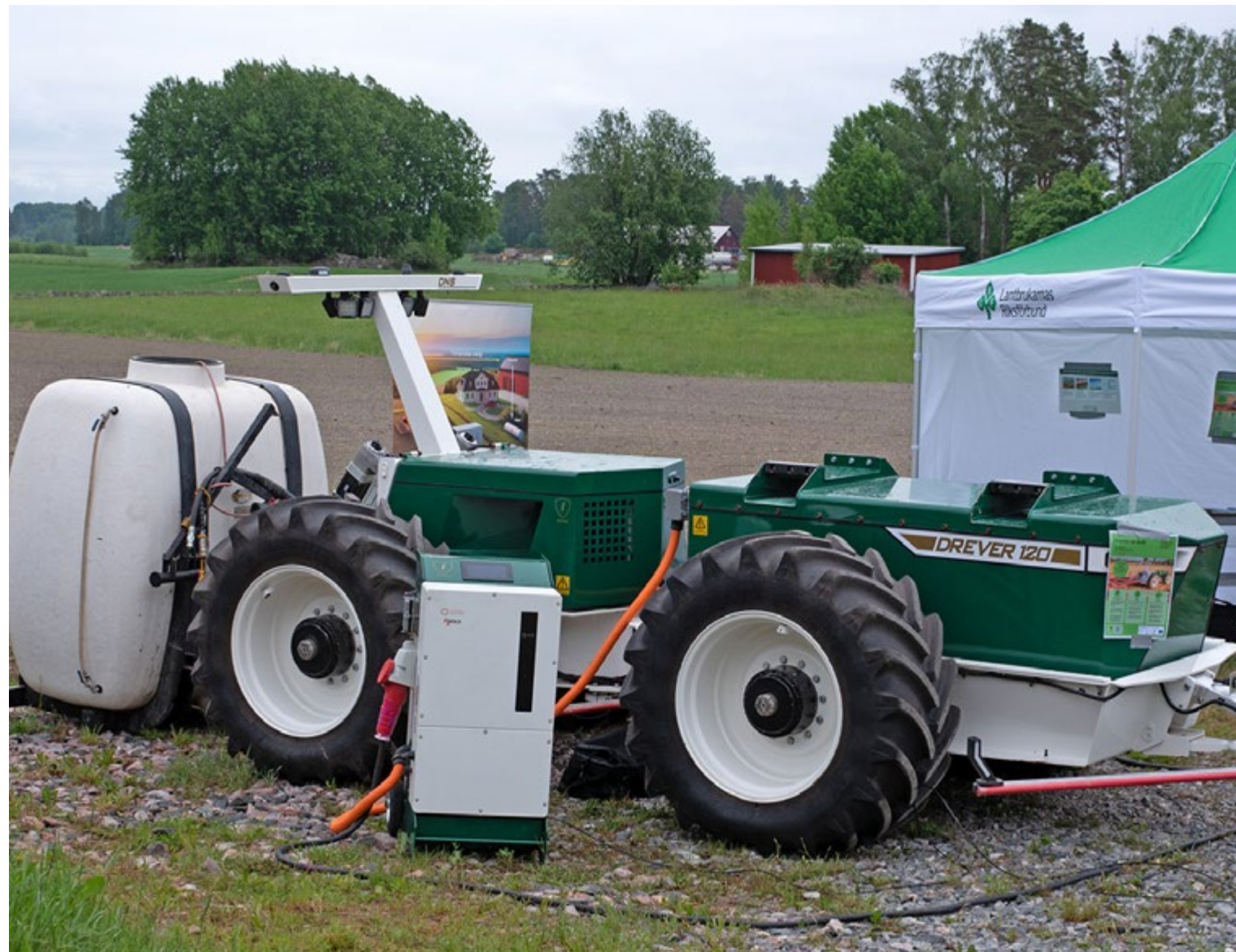
Drever 120 är en självkörande och eldriven jordbruksmaskin, där batteriet även kan användas för andra ändamål inom energi.
